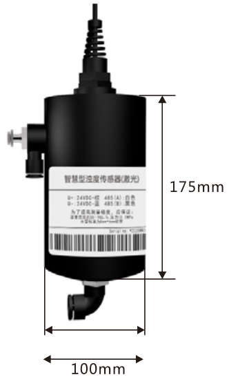
图 8 浊度电极尺寸图
